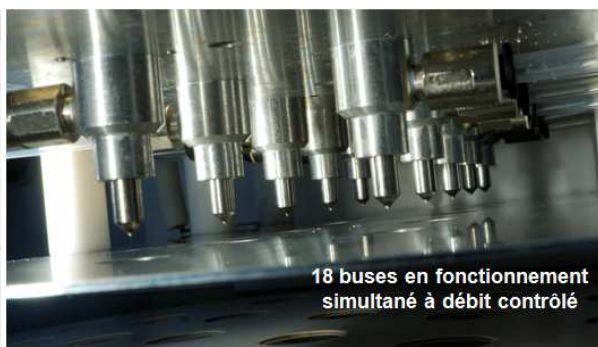
Vue de la tête de pulvérisation comportant 18 buses fonctionnant simultanément
