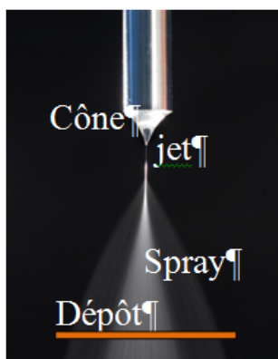
Effet du champ électrique sur la une goutte
